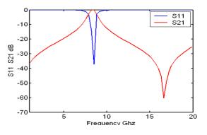
Fig.3 Scattering parameters S11 and S21
